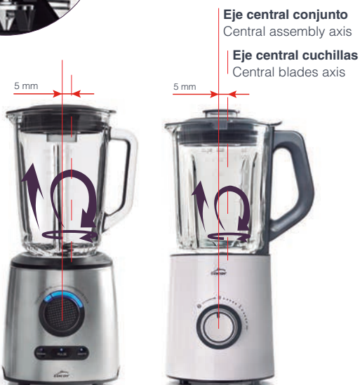
Eje central de las cuchillas descentrada respecto al eje central del conjunto. Crea vórtices irregulares, evita obstrucciones y genera cortes más profundos. Central blade axis offset from the central assembly axis. Creates uneven vortices, avoid blockages and make deeper cuts.
